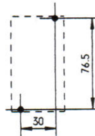
Maßbild für Anbau Schaltereinheit MS 25 Startermounting dimensions MS 25 and MST 25
